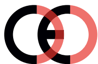
Marcatura CE contraffatta (troppo vicino)
